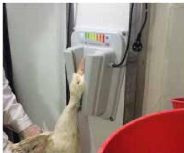
Si, à la fin du cycle d'anesthésie, il vous semble que l'animal n'est pas totalement inconscient, repositionnezle entre les électrodes, et relancez un cycle.
